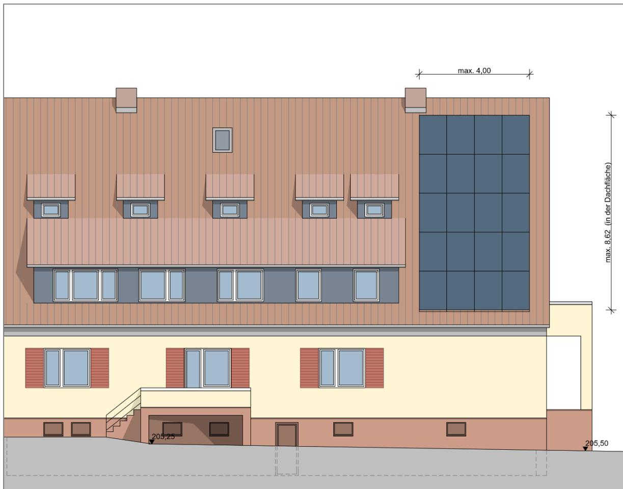
Abbildung 19: Südansicht des Gebäudes Riedwiesen 43 mit projektierte und mit der Denkmalbehörde abgestimmter Photovoltaikanlage
